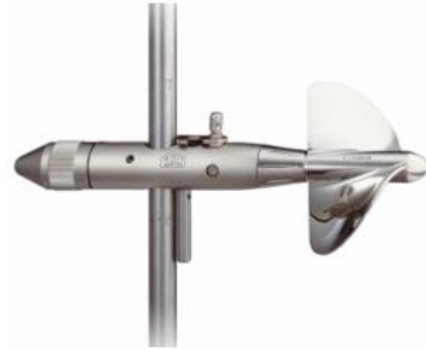
Figura 17. Micromolinete de medição de vazão.
