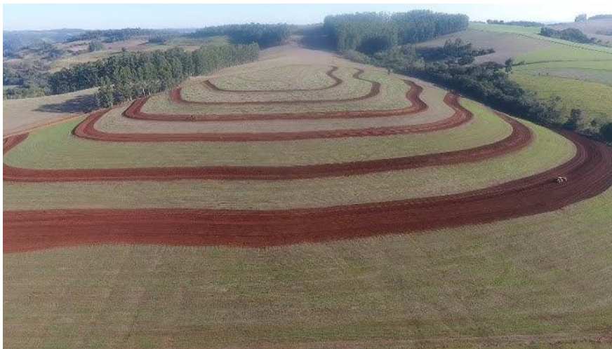
Figura 21. Terraço em nível em área de pastagem.
